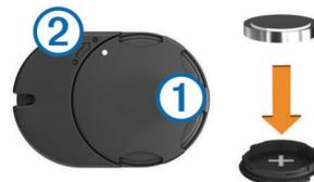
**2** Tournez le cache dans le sens inverse des aiguilles d'une montre jusqu'à ce qu'il soit suffisamment desserré pour pouvoir être retiré.
